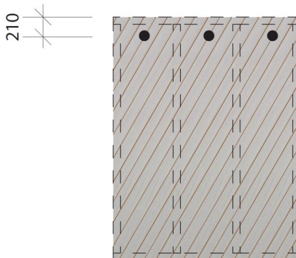
Bild 1: Öffnungen für Einblasdämmstoffe in GFM-Platten
