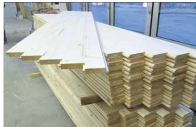
Die ineinandergeschobenen Bretter bilden eine einstoffliche hölzerne Ebene für den Holzrahmen- und Holztafelbau.
