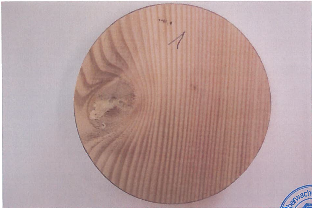
Bild 1: Prüfkörper 1; ohne Fuge (Ast \varnothing 25 mm)
